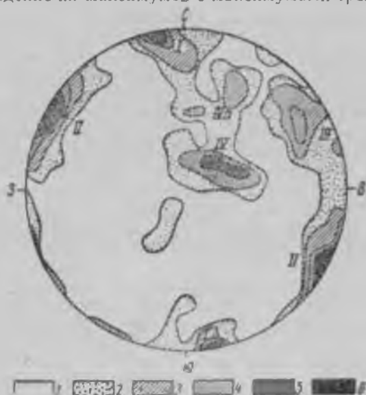
Рис. 1. Диаграмма ориентировки трещин в верхнепротерозойских породах. 300 замеров 1 — <1\% ; 2 — от 1 до 2%; 3 — от 2 до 3%; 4 — от 3 до 4%; 5 — от 4 до 5%; 6 — >5\%
