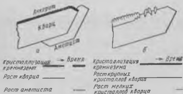
Рис. 1. Соотношения кварца, анкерита и аметиста, схема последовательности кристаллизации кремнезема и роста кристаллов кварца и аметиста (а); соотношение кристаллов кварца разной величины, схема последовательности кристаллизации кремнезема и роста крупных и мелких кристаллов кварца (б). Приполярный Урал
