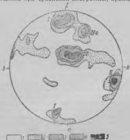
Рис. 2. Диаграмма ориентировки кварцевых жил в верхнепротерозойских породах. 110 замеров жил 1 — <1\% ; 2 — от 1 до 3%; 3 — от 3 до 4%; 4 — от 4 до 6%; 5 — >6\%
