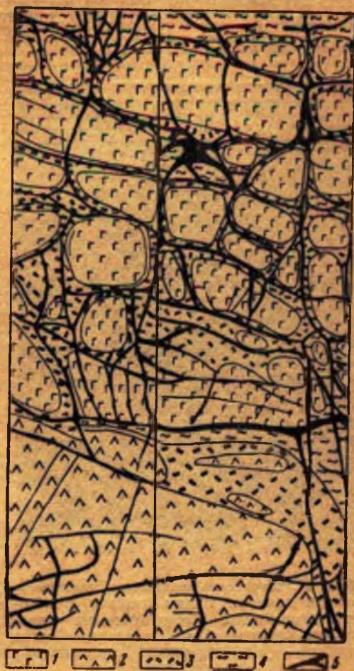
Рис. 28. Выклинивание пироксено-цеолитовой породы на глубине. Джекиндинское месторождение, зарисовка стенок шурфа (по К. Ф. Гурьянову)
