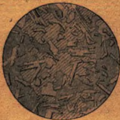
Рис. 12. Базальт пойкилоофито-интерсертальной структуры, р. Чунчек. Удлиненные лейсты лабрадора включены в ксеноморфные зерна моноклинного пироксена. Серое — вулканическое стекло. Диаметр поля зрения 2 мм (без анализатора)
