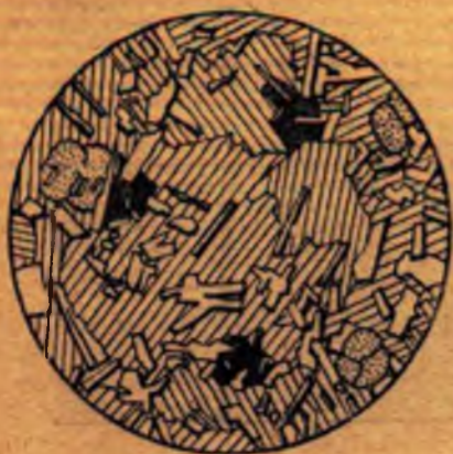
Рис. 17. Оливиновый долерит пойкилофитовой структуры, р. Средняя Кочема. Лейсты лабрадора включены не только в моноклинный пироксен (косая штриховка), но и в изометричные зерна оливина. Черное — титано-магнетит. Диаметр поля зрения 3 мм (без анализатора)
