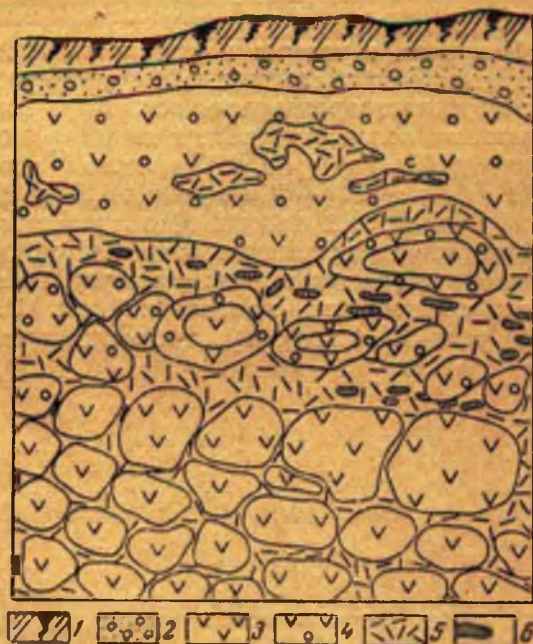
Рис. 42. Строение линзы шаровой лавы. Зарисовка забоя карьера, участок 1, II покров (по Е. И. Гуриновой) 1 — почвенный слой; 2 — делювий; 3 — базальт; 4 — мандельштейн; 5 — дресва; 6 — скопление кальцита и цеолитов
