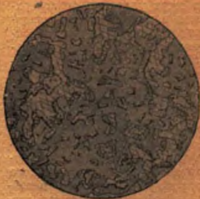
Рис. 13. Мандельштейн. Гиалопилитовая структура, миндалекаменная текстура, р. Чунчек. В вулканическом стекле беспорядочно распределены кристаллики плагиоклаза. Неправильные ветвящиеся миндалины сложены кальцитом с каймой халцедона. Диаметр поля зрения 2 мм (без анализатора)
