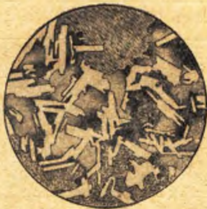
Рис. 50. Хлоритизированный базальт. Вулканическое стекло (черное) и частично пироксен (косая штриховка) замещаются хлоритом. Диаметр поля зрения 2 мм (без анализатора)
