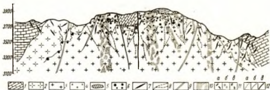
Рис. 1. Принципиальная схема размещения хрусталеносных пегматитов и кварц-полевошпатовых тел в интрузивах гранитоидов северной части Тянь-Шаня: 1 — осадочные и метаморфические породы; 2 — кварцевые диориты, гранодиориты и другие породы первой и второй фаз интрузивных комплексов; 3 — лейкократовые граниты третьей фазы интрузивных комплексов; 4 — мелко- и среднезернистые приконтактные граниты начального этапа затвердевания гранитного интрузива; 5 — скарны; 6 — шширообразные пегматиты; 7 — жильные пегматиты; 8 — жилы аплита и мелкозернистого гранита; 9 — дайки лампрофиров; 10 — гидротермально измененные граниты крутопадающих зон повышенной трещиноватости; 11 — кварц-полевошпатовые тела; а) олигоклаз-андезиновые; б) кварц-микроклиновые; в) скарново-полевошпато-кварцевые; 12 — типы контактов: а) постепенные; б) интрузивные; в) тектонические (сбросы)
