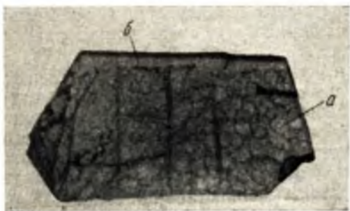
Рис. 5. Соотношение пневматолитового (а) и гидротермального (б) кварца в кристалле
