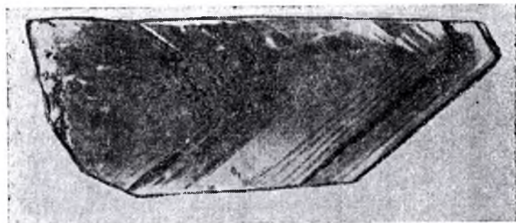
Рис. 43. Пластика кристалла кварца (срез Z) искаженного облика. На гранях ромбоэдров, обращенных кверху, видны обильные включения твердых фаз (хлорит, серицит). \times 1
