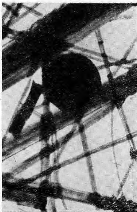
Рис. 1. Нитевидные и сферолитовые выделения кристобалита. Одноступенчатая угольная реплика. Увел. 10800
