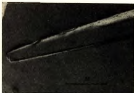
Рис. 83. Площадка с капелькой на конце волокна синтетического муллита — платиноугольная реплика
