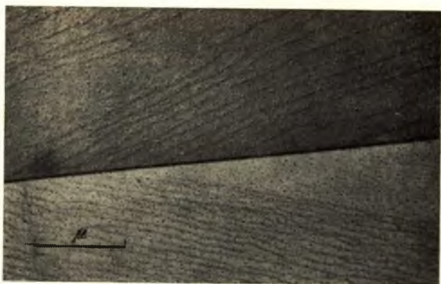
Рис. 82. Выходы слоев роста на плоскости грани (110) синтетического муллита
