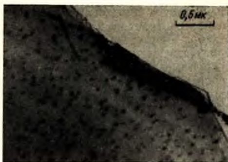
Рис. 105. Пластинчатые сегрегации примеси азота в алмазе
