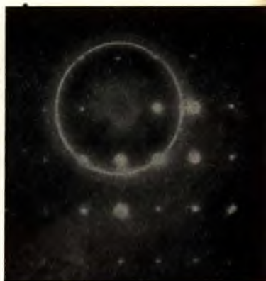
Рис. 84. Точечная электронограмма волокна муллита сечения ( h0l )
