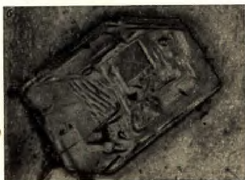
Рис. 55. Фигуры травления на плоскости \{100\} кристаллов ИАГ:
