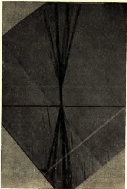
Рис. 16. Рентгенограмма кристалла, на которой наблюдаются пучки дислокации в наросте пирамиды (0001), следующие от участков регенерации трещины в затравке.
