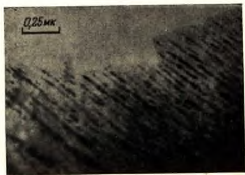
Рис. 107. Включения в зернах импактных алмазов.
