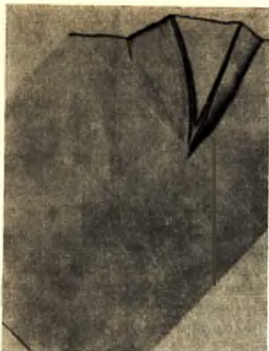
Рис. 15. Рентгенопограмма бездислокационного кристалла, выращенного на затравке, параллельной плоскости (\bar{1}120) . Дифракционный контраст возник в результате формирования «паразитных» секторов тригональной пирамиды.
