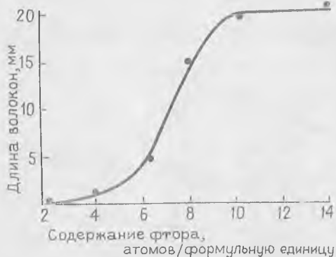
Рис. 32. Зависимость длины волокон магнезиофторрихтерита от содержания фтора в исходной шихте (температура синтеза 900—950° С, выдержка 30 ч) [14]
