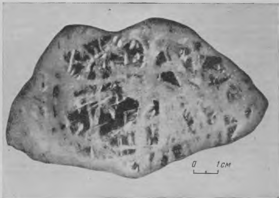
Рис. 9. Прожилки гранулированного кварца в прозрачном блокованном жильном кварце (фото в отраженном свете)
