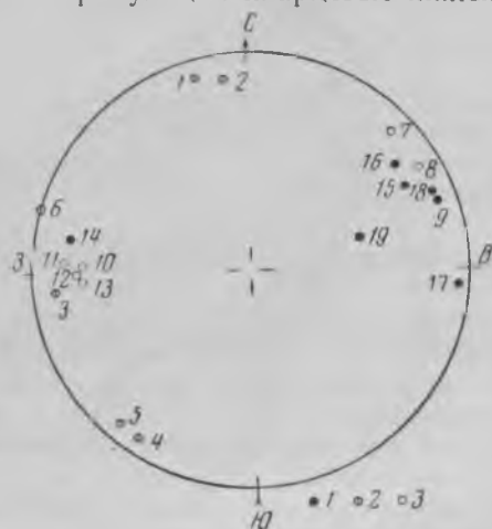
Рис. 6. Стереографическая проекция микротрещин в штуфе кварца, показанного на рис. 5
