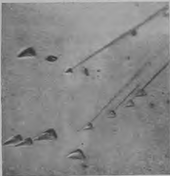
Рис. 6. Фигуры травления с каналами и без них. x 400
