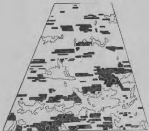
Рис. 2. Бразильские и дофинейские двойники, выявленные травлением шлифованной поверхности кварца ( a ), дофинейские двойники ( б ), бразильские двойники на той же поверхности того же образца, видимые при ином, косом, освещении ( в )
