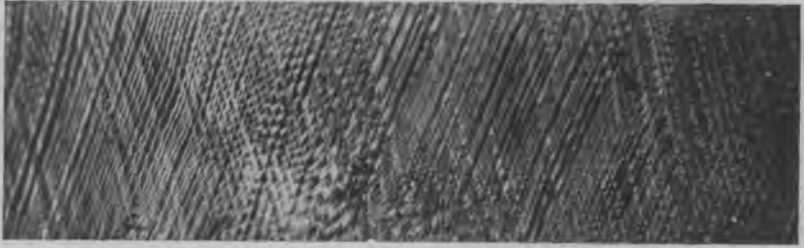
Рис. 3. Сетчатый скол пластинки толщиной 0,8 мм из свлеватого кварца
