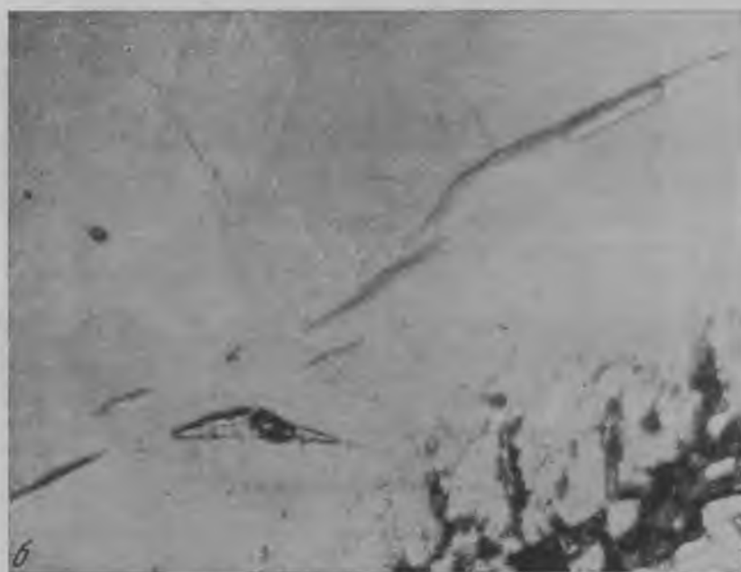
Рис. 6. Двухфазовые включения в кристалле кальцита. х 40 а — первичное включение, возникшее в процессе скелетного роста кристалла; б — вторичное включение, образовавшееся при заживлении трещины спайности кальцита
