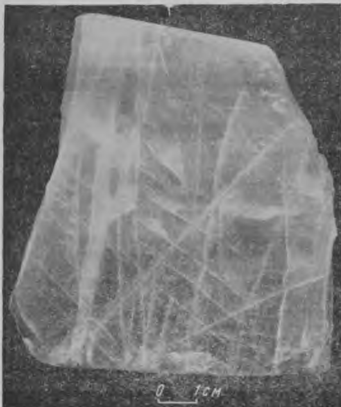
Рис. 5. Жильный стекловидный кварц. Белые полосы — залеченные трещины
