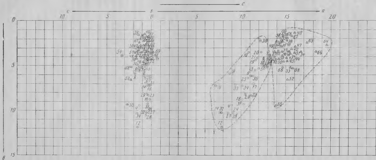
Рис. 2. Диаграмма химических составов гранитов, слагающих интрузивы с промышленными месторождениями горного хрусталя, оптического флюорита и редких металлов (составлена по методу А. Н. Заварицкого). Номера фигуративных точек соответствуют номерам химических составов гранитов в табл. 3
