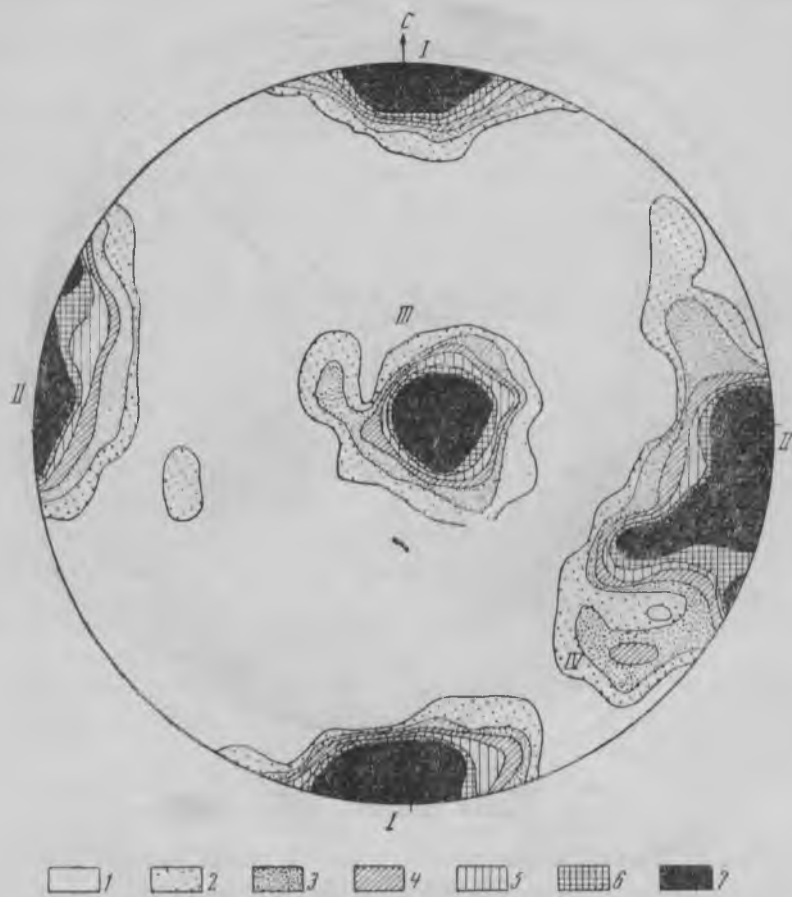
Рис. 3. Диаграмма ориентировки трещин в гранитах Байшоринского участка. 405 замеров
