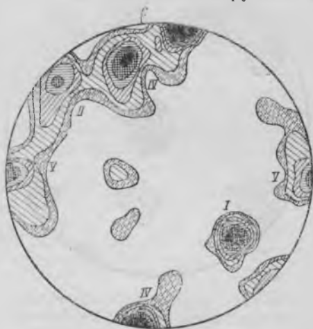
Рис. 9. Диаграмма ориентировки кварцевых жил и прожилков в бассейне р. Окурдан. 110 замеров. Изолинии проведены через <1—2—4—6—8—10>%
