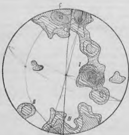
Рис. 7. Диаграмма ориентировки кварцевых жил и прожилков в бассейне р. Бугарыхта. 70 замеров. Изолинии проведены через \langle 1-2-4-6-8-10-14 \rangle \%
