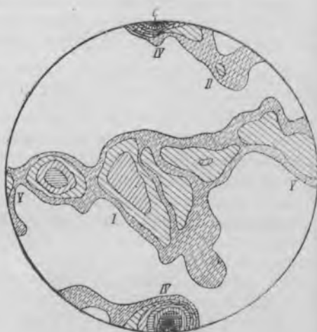
Рис. 8. Диаграмма ориентировки кварцевых жил и прожилков в бассейне р. Малый Нихот. 202 замера. Изолинии проведены через \langle 1-2-4-5-10-15-20 \rangle \%
