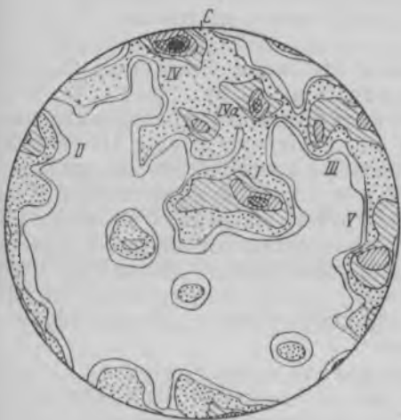
Рис. 5. Диаграмма ориентировки трещин в карьере проявления в протерозойских породах. 120 замеров. Изолинии нанесены через <0,5-1-3-5-7-9>^{\circ}/_0
