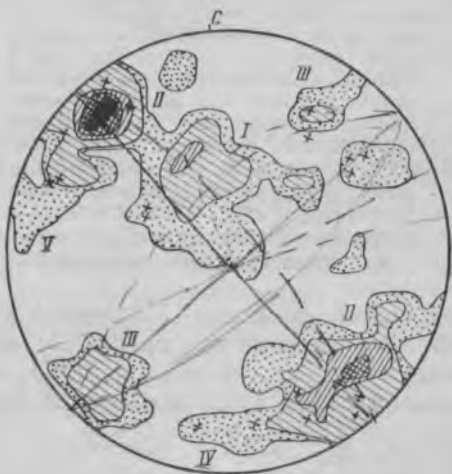
Рис. 1. Диаграмма ориентировки трещин в архейских породах. 150 замеров. Изолинии проведены через \langle 1-2-4-6-10 \rangle \% . + — кварцевые жилы
