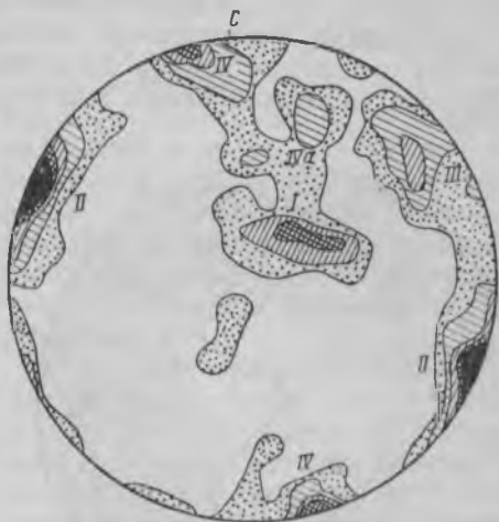
Рис. 3. Диаграмма ориентировки трещин в верхнепротерозойских породах. 300 замеров. Изолинии нанесены через \langle 1-2-3-4-5 \rangle^\circ
