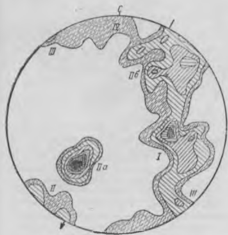
Рис. 1. Диаграмма ориентировки пегматоидов в бассейне р. Митинга. 101 замер. Изолинии проведены через <1—2—4—6—8—10>%. Стрелкой показано направление погружения шарнира антиклинали
