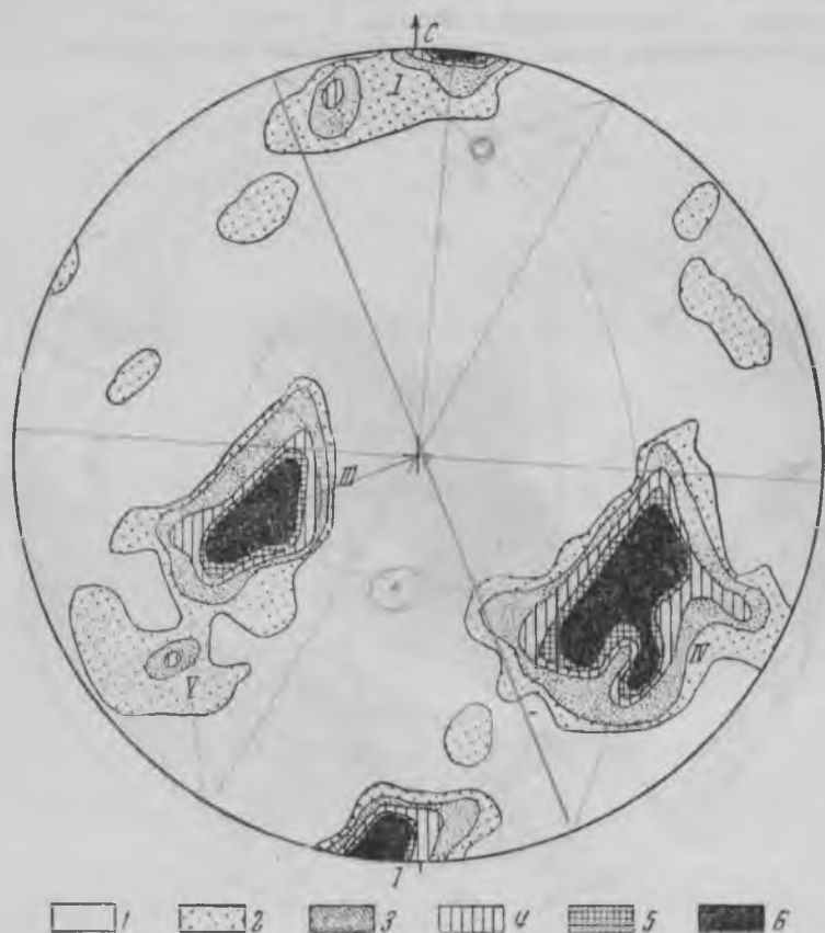
Рис. 5. Диаграмма ориентировки трещин в пегматитах жильного типа (Байшоринский участок). 120 замеров I — IV — системы трещин; 1 — 1%; 2 — 2%; 3 — 3%; 4 — 4%; 5 — 5%; 6 — >5%
