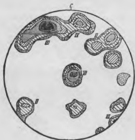
Рис. 10. Диаграмма ориентировки послекварцевых трещин в бассейне р. Митинга. 171 замер. Изолинии проведены через <1-2-4-6-10-15>^{\circ}/_0
