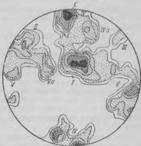
Рис. 6. Диаграмма ориентировки кварцевых жил в протерозойских породах. 94 замера. Изолинии проведены через <0,5-1-2-3-4-6-8>^{\circ}/_0
