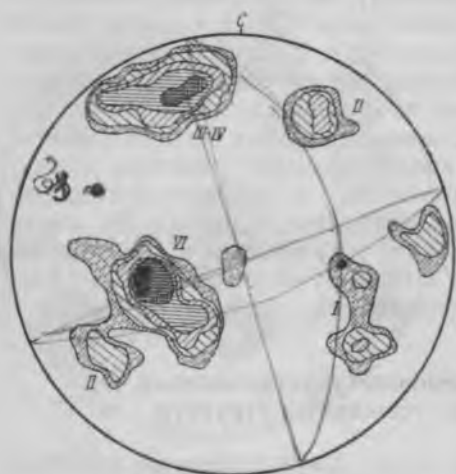
Рис. 13. Диаграмма ориентировки трещин в кварцитах, вмещающих жильные зоны. 320 замеров. Изолинии проведены через <1—2—4—6—10—15>%.
