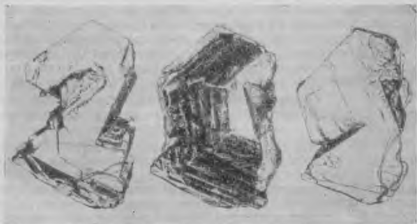
Рис. 4. Расколотый по спайности кристалл (опыт № 3). Включения приурочены к пирамидам роста псевдогексагональной призмы и расположены в центральной части кристалла
