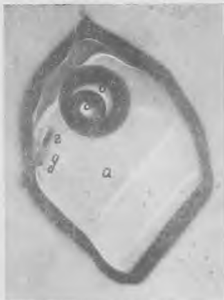
Рис. 5. Многофазное жидкое включение: а — водный жидкий раствор; б — газ; в — жидкая углекислота, г, д — неизвестные минералы. Увеличение 500
