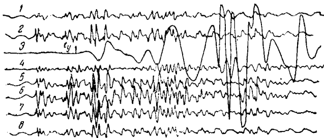
Рис. 12. Длительный процесс записи электрических колебаний, связанных с разлетом наэлектризованных частиц горной массы и неполностью прореагировавшего ВВ
