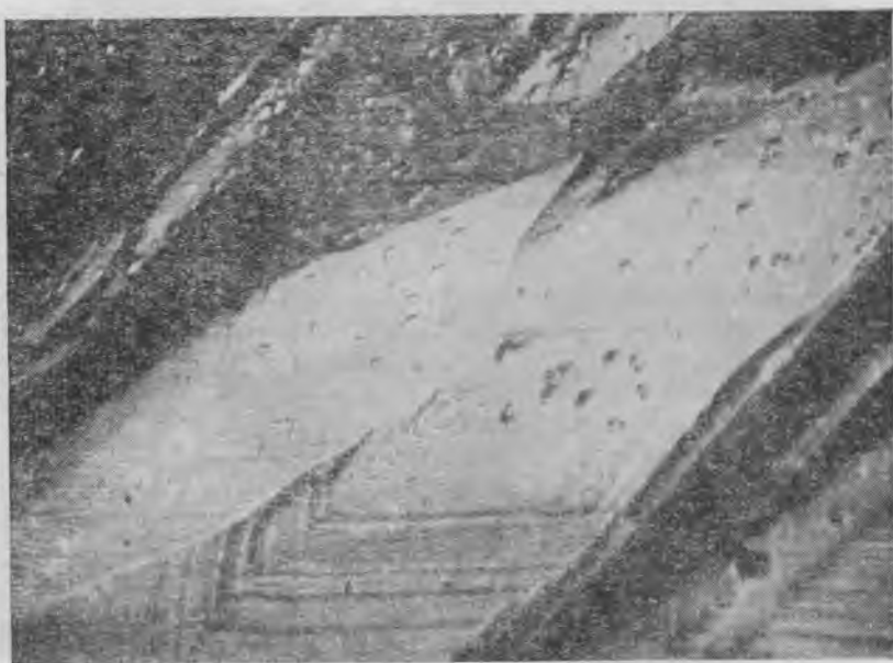
Рис. 8. Фигуры роста на грани m . Слопетый характер роста. Левый кристалл. \times 20
