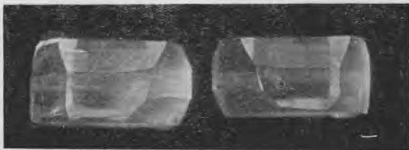
Рис. 1. Два кристалла искусственного кварца. Ориентировка: ось L_3 вертикальна; одна из осей L_2 горизонтальна
