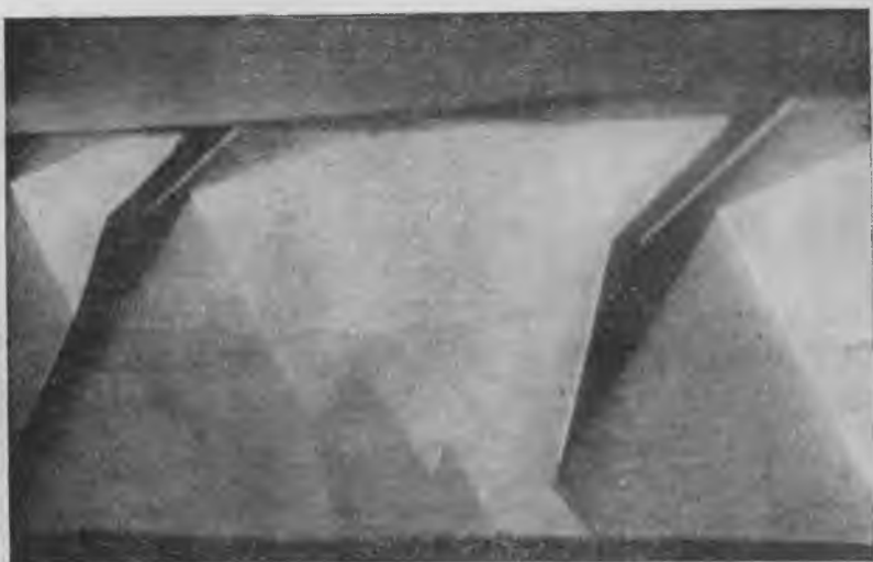
Рис. 5а. Фигуры на грани m . Левый кристалл. \times 20 . Ориентировка: плоскость снимка совпадает с плоскостью m ; ось L_3 кристалла вертикальна, одна из осей L_2 горизонтальна; грань R расположена выше, а грань r ниже изображенной грани m
