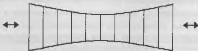
Рис. 2. Одноосное растяжение кристалла вдоль направления [100].
