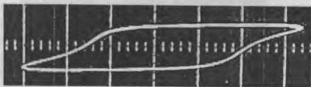
Рис. 1. Петля диэлектрического гистерезиса в беспримесном кристалле SBN. E=4,4 кВ/см.
