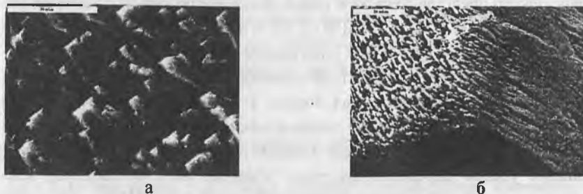
Рис. 2. Микроморфология граней ромбоэдра кристаллов (Tm_xY_{1-x})Al_3(BO_3)_4 первого типа.
