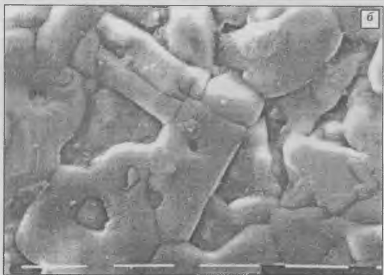
Рис. 3. Поверхность объемных образцов YBCO, при синтезе употреблен отожженный оксид меди: a – нетравленная поверхность YBCO, масштаб 5 мкм; б – термически травленая поверхность YBCO, масштаб 5 мкм.
