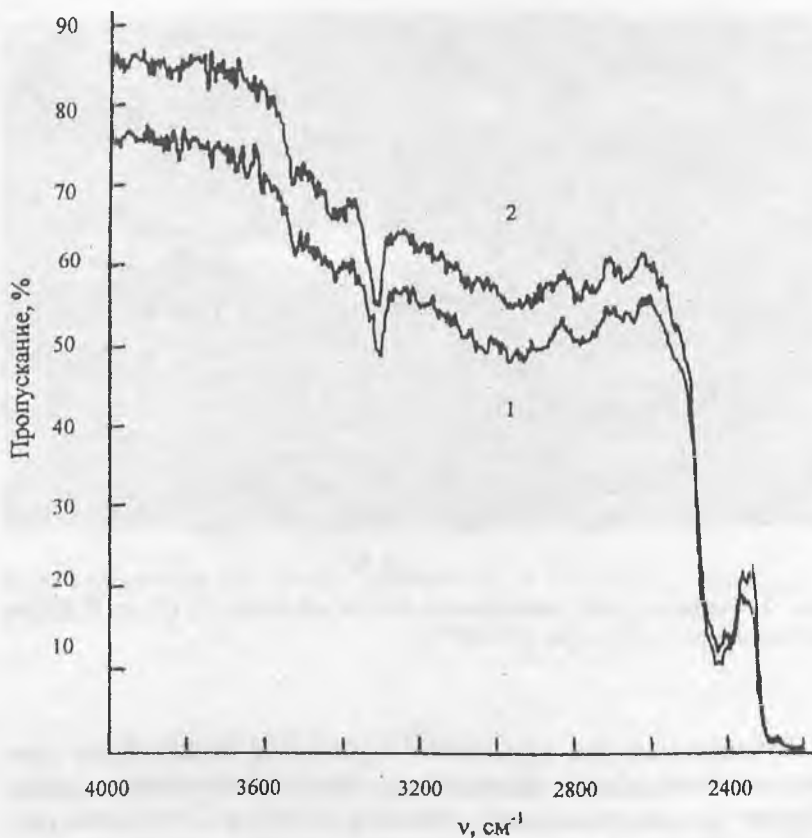
Рис. 6. Типичные ИК-спектры пропускания кристаллов берлинита из сернокислых растворов:
