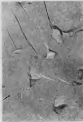
Рис. 1. Признаки, позволяющие распознавать полости газозо-жидких включений.
