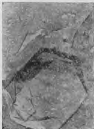
Рис. 4. Псевдогексагональная форма включения, экранированная пластинчатым кристаллом глинистого минерала в кварце месторождения Бале́й (колл. Н. В. Петровской). Увел. 11000. Платино-угольная реплика.
