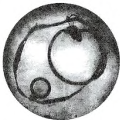
Фото 1. Первичное расплавленное включение в корунде: стекло + газ + углекислота + биотит
