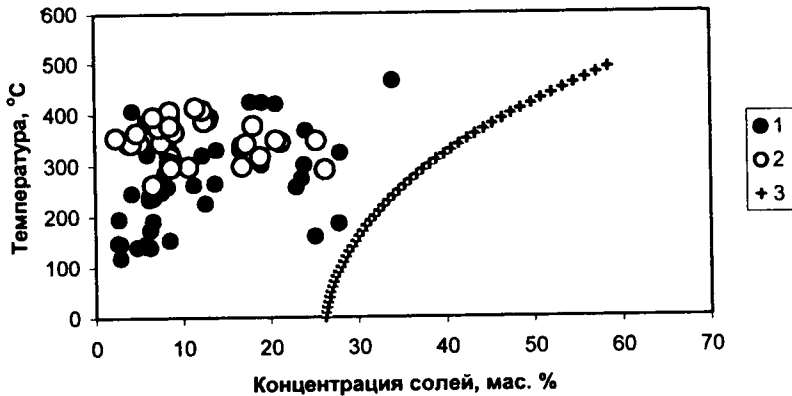
Рис. Зависимость изменения концентрации солей от температуры гомогенизации для рудообразующих флюидов месторождения Теремки. 1 – гомогенный водный флюид, 2 – гетерогенный флюид (водный раствор + газовая фаза), 3 – кривая насыщения системы H 2 O-NaCl (Bodnar, Vityk, 1994).
