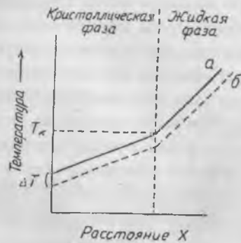
Рис. 3. Условия роста грани. T_k - термодинамическая (равновесная) температура кристаллизации, \Delta T - переохлаждение, a — изменение температуры при равновесных условиях существования расплав - кристалл (теоретический случай), b - изменение температуры при неравновесных условиях - кристаллизация минерала из расплава (реальное изменение температуры при кристаллизации).
