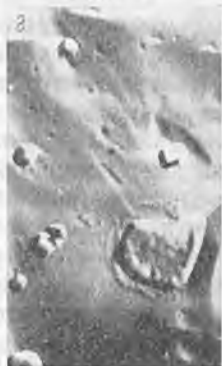
Рис. 11. Поверхность скола (а) и границы зерен гранулированного кварца формации П.А.1 с фигурами природного травления (б), полостями от газожидких включений (в) и аксессуарами роста — растворения (г). Средний Урал. Электронно-микроскопическая фотография угольной реплики. Увел. 12 000
