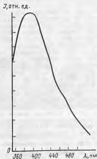
Рис. 3. Спектр фотолюминесценции монокристалла GdTaO_4 ( \lambda_{ex}=225 нм)
