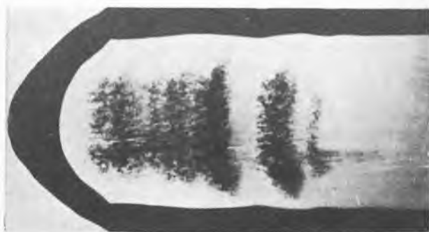
Рис. 1. Центральная и хвостовая зоны кристаллов молибдата бария-гадолиния
