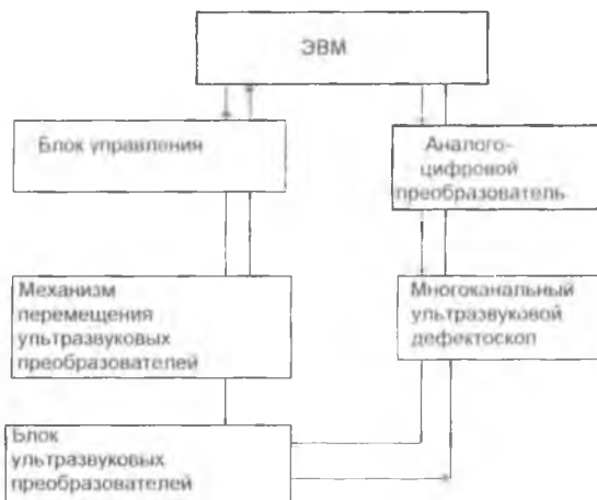
Рис. 5. Упрощенная структурная схема автоматизированной системы контроля с ЭВМ.
