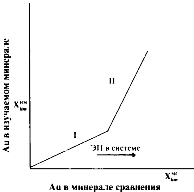
Рис. 3. Характер распределения золота между исследуемым минералом и минералом сравнения при постоянных P, T -параметрах и меняющейся концентрации ЭП.
