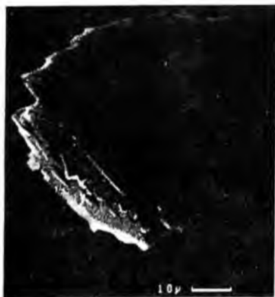
Рис. 2. Кристалл КНБ, полученный во флюиде (образцу 2).
