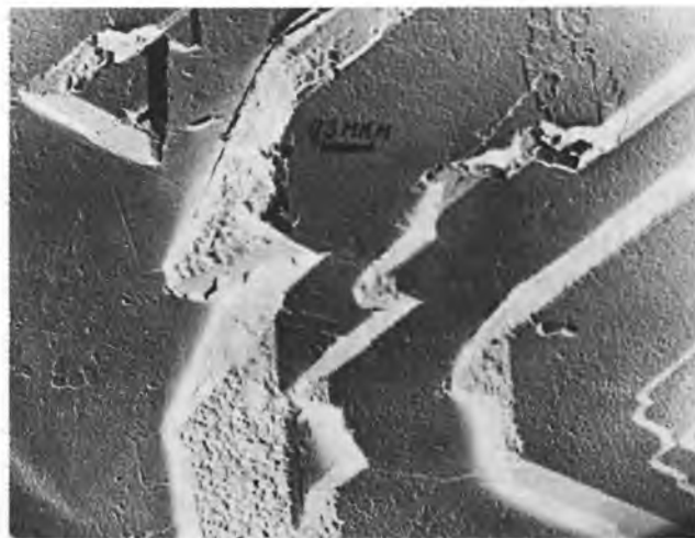
Рис. 4. Фигуры роста графитовой пленки на грани \{111\} алмаза
