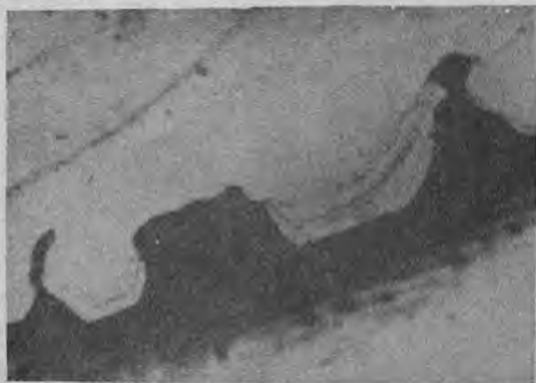
Рис. 14. Образование включений по входящем углу роста. Ув. 100
