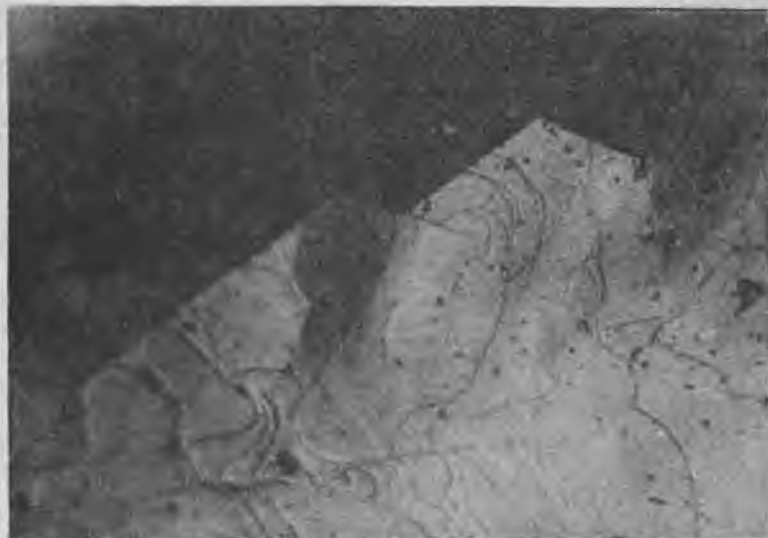
Рис. 11. Расщепление кристалла на грани (001). Ув. 100
