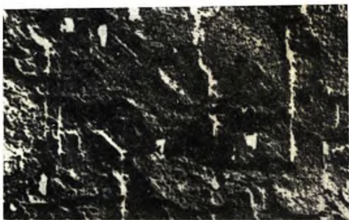
Рис. 60. Электронно-микроскопический снимок срастания грани куба. \times 16\,000 . Угольная реплика с оттенением платиной
