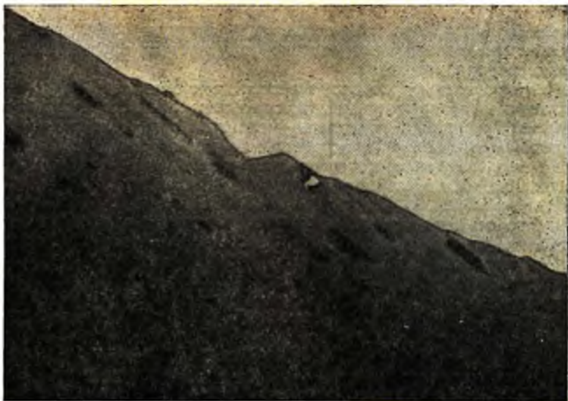
Рис. 84. Электронно-микроскопический снимок синтетического алмаза на просвет. \times 100\,000 .
