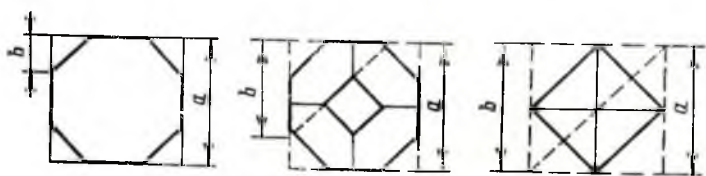
Рис. 42. Схема, показывающая изменение соотношения при формировании кубических и октаэдрических граней кристалла алмаза
