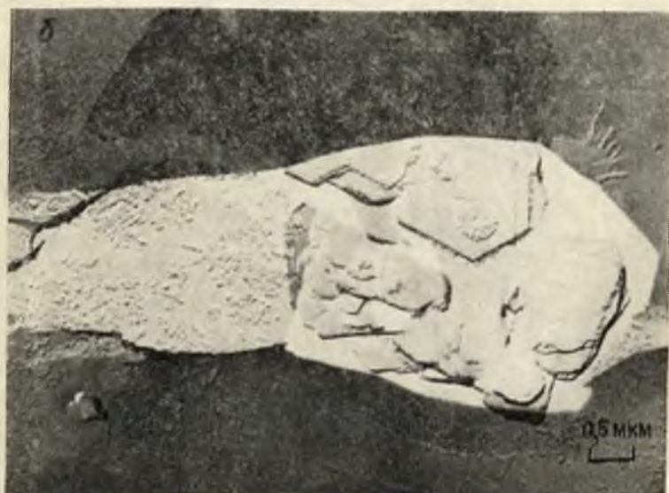
Рис. 25. Слоистые твердые включения и следы газовой-жидкой фазы вокруг них.
