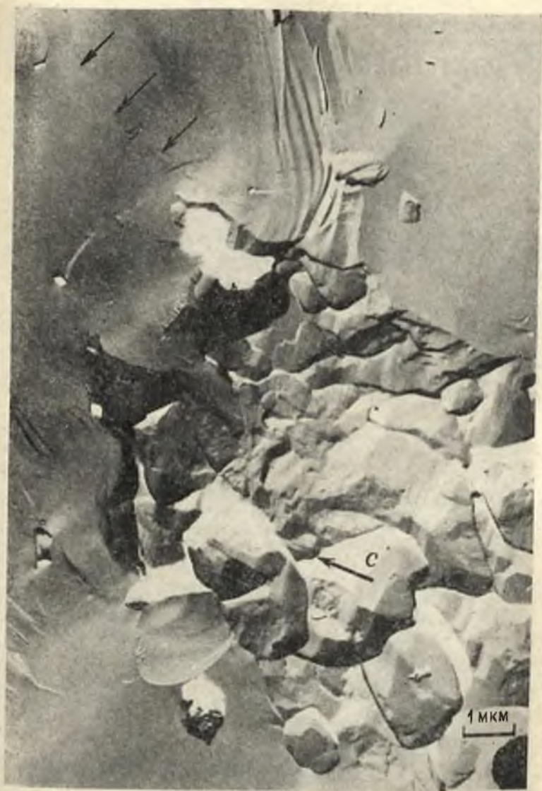
Рис. 27. Твердые включения микрокристаллов кварца на границе кварцевых зерен.
