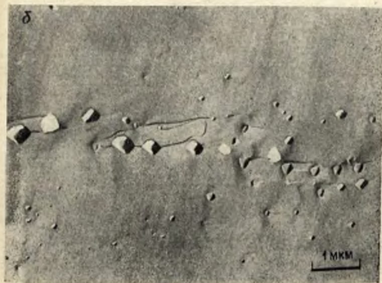
Рис. 35. Поры и субмикроскопические включения, распределенные вдоль залеченных трещин. Формация мусковитовых пегматитов, Карелия. Кварц гигантозернистый непрозрачный
