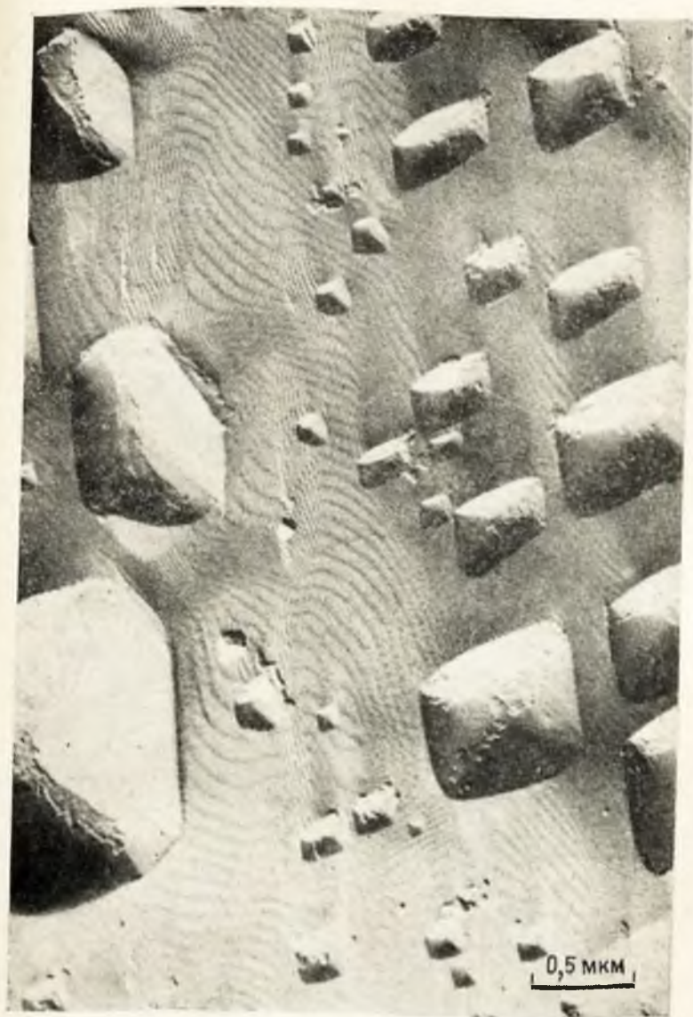
Рис. 41. Поверхность излома по межкристаллитной границе в природном кварце.
