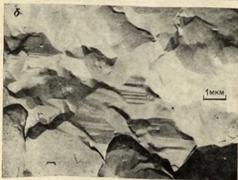
Рис. 51. Грубая скульптура роста на поверхности кварца: а — синтетический кварц; б — природный кварц
