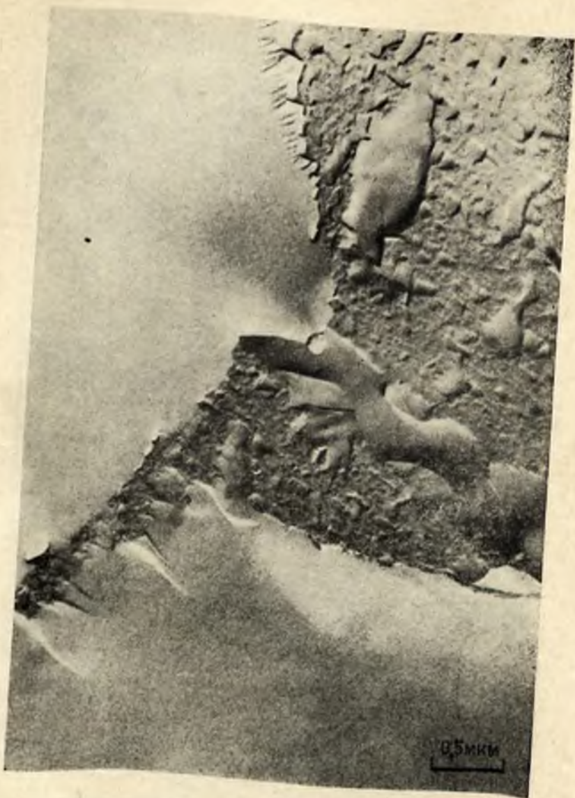
Рис. 65. Поверхность излома вдоль реликтовой микротрещины, частично выходящей на поверхность скола. Силекситовая формация. Средний Урал. Кварц гранулированный мелкозернистый
