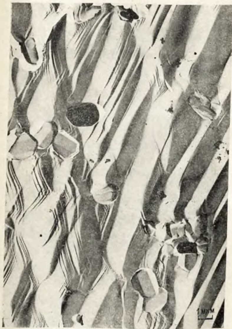
Рис. 19. Микрористаллы акмита на пинакоидальном слое (0001) синтетического кварца.
