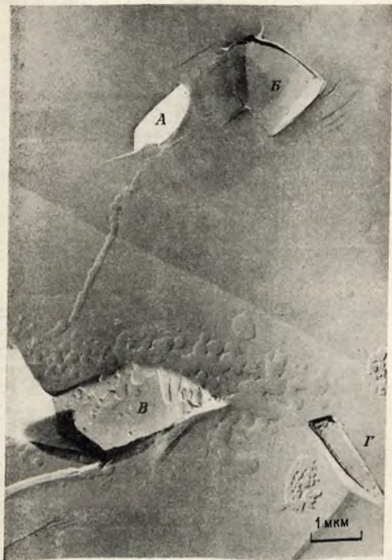
Рис. 9. Газово-жидкие включения, имеющие различный состав и концентрацию газовой-жидкой фазы.
