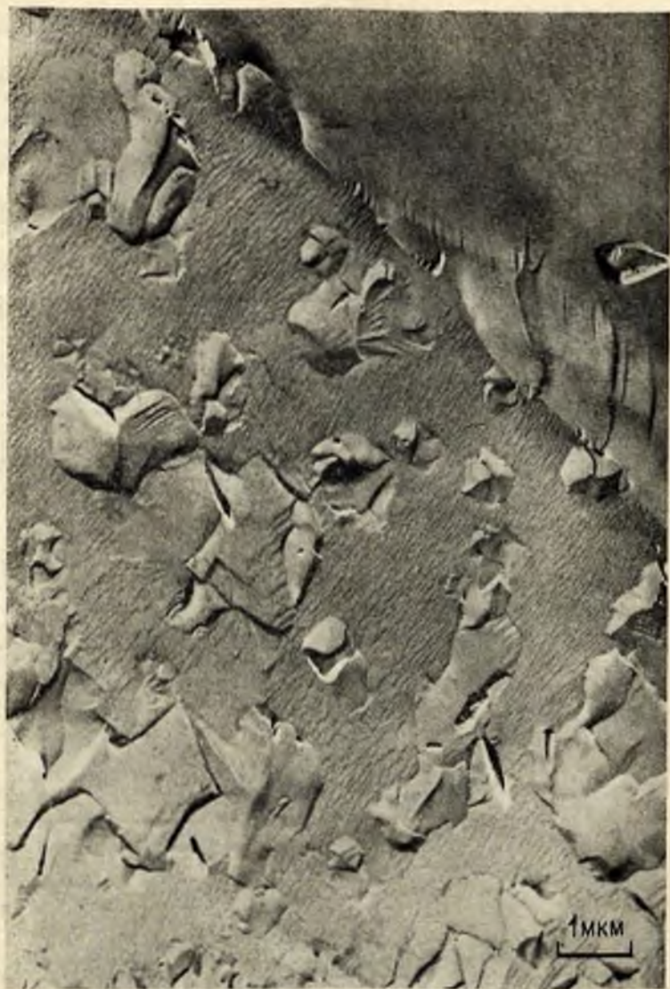
Рис. 62. Поверхность излома вдоль реликтовой микротрещины. Силекситовая формация. Средний Урал. Кварц гигантозернистый непрозрачный
