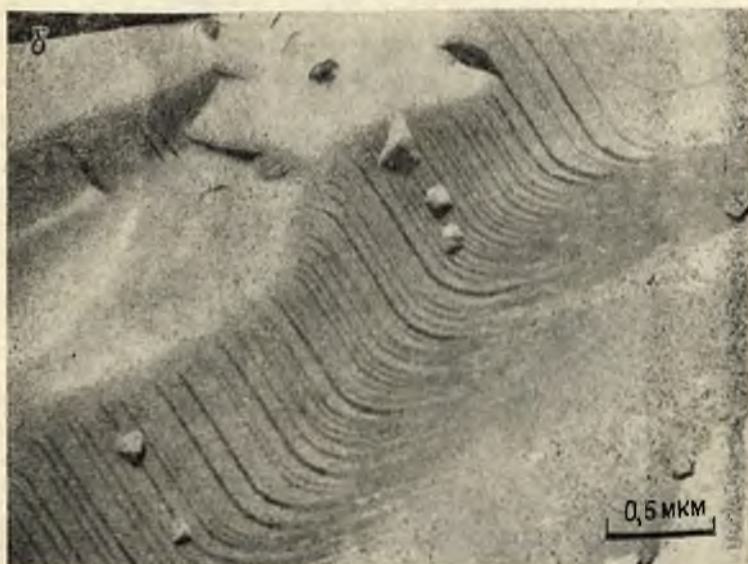
Рис. 52. Ступени роста на поверхности кварца: а — синтетический кварц; б — природный кварц. Кварц гранулированный мелкозернистый
