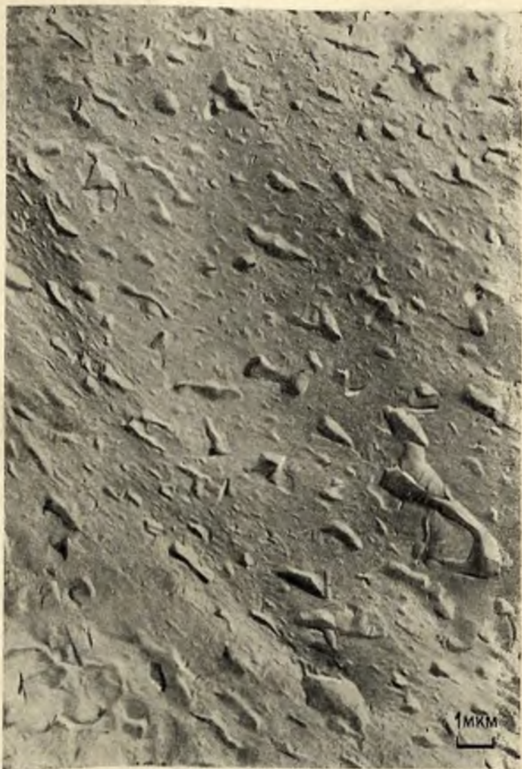
Рис. 63. Поверхность излома вдоль реликтовой микротрещины. Мусковит-пегматитовая формация. Карелия. Кварц гигантозернистый непрозрачный
