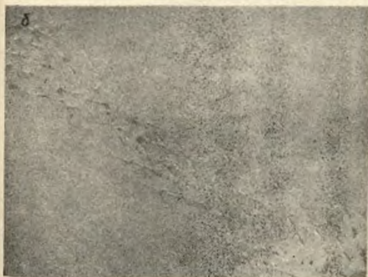
Рис. 43. Поверхность излома по межкристаллитной границе с очень малой разориентацией:
