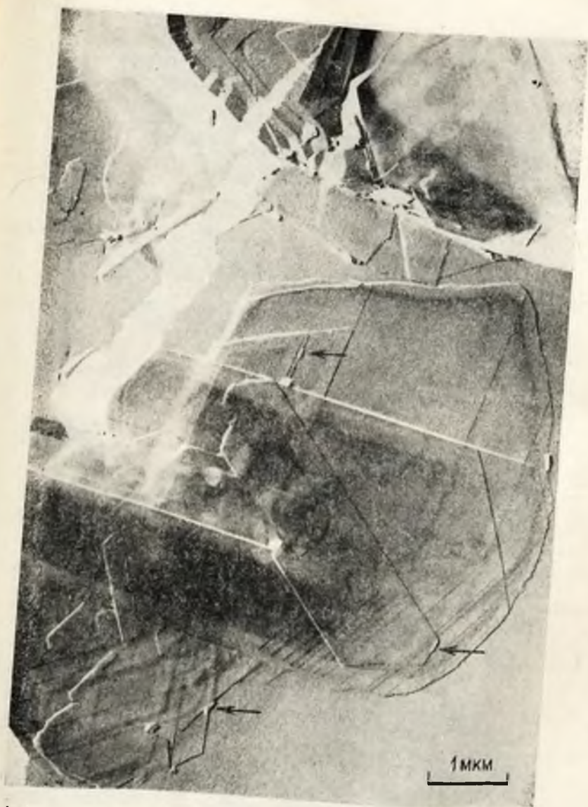
Рис. 21. Агрегат твердых слоистых включений, извлеченных на реплику.
