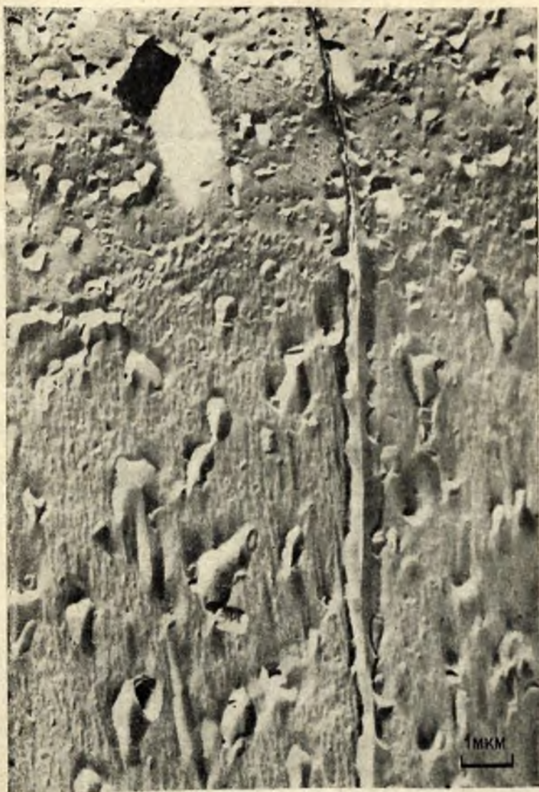
Рис. 64. Поверхность излома вдоль реликтовой микротрещины. Силекситовая формация. Средний Урал. Кварц гигантозернистый непрозрач- ный
