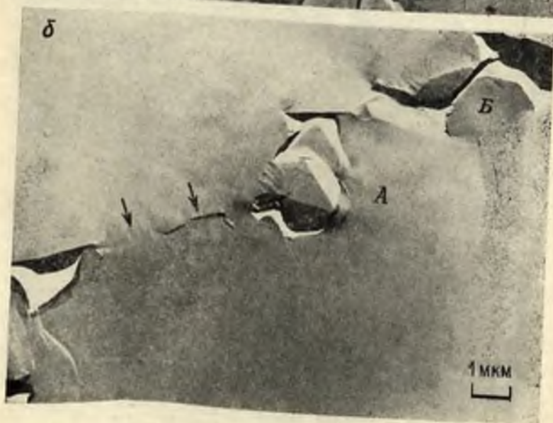
Рис. 28. Твердые включения на границе кварцевых зерен: а — излом по границе зерен, б — скол поперек границы. Стрелками указаны границы зерен на поверхности сколов. Дистен-сланцевая кварцево-жильная формация Южный Урал. Кварц гранулированный среднезернистый
