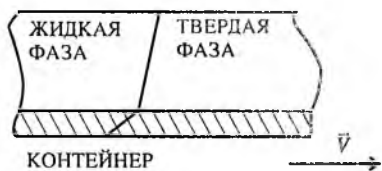
Рис. 7. Форма изотермы, совпадающая с фронтом кристаллизации при выращивании лазерных кристаллов граната.
