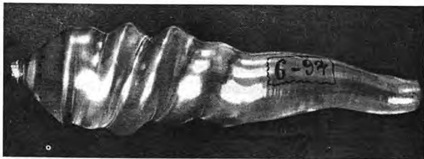
Рис. 45. Винтообразная форма поверхности кристалла BGO.
