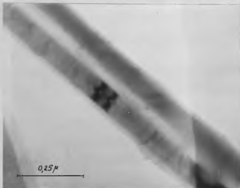
Рис. 13. V-образное искажение контура экстинкции, свидетельствующее о наличии винтовой дислокации.
