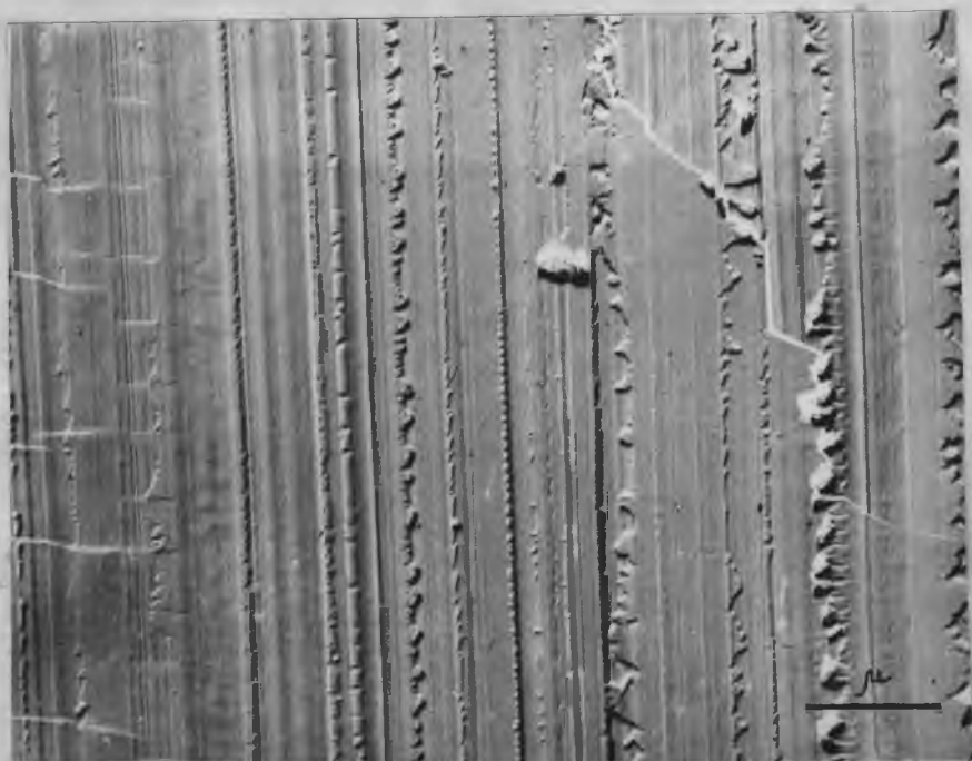
Рис. 9. След индентора /с поперечным размером острия в несколько микрон/ на свежесколотой поверхности кварца.
