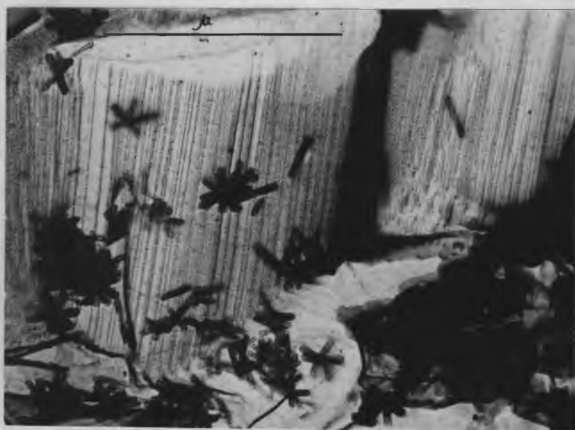
Рис. 10. Картины вакуумного декорирования золотом граней синтетического фторамфибола.
