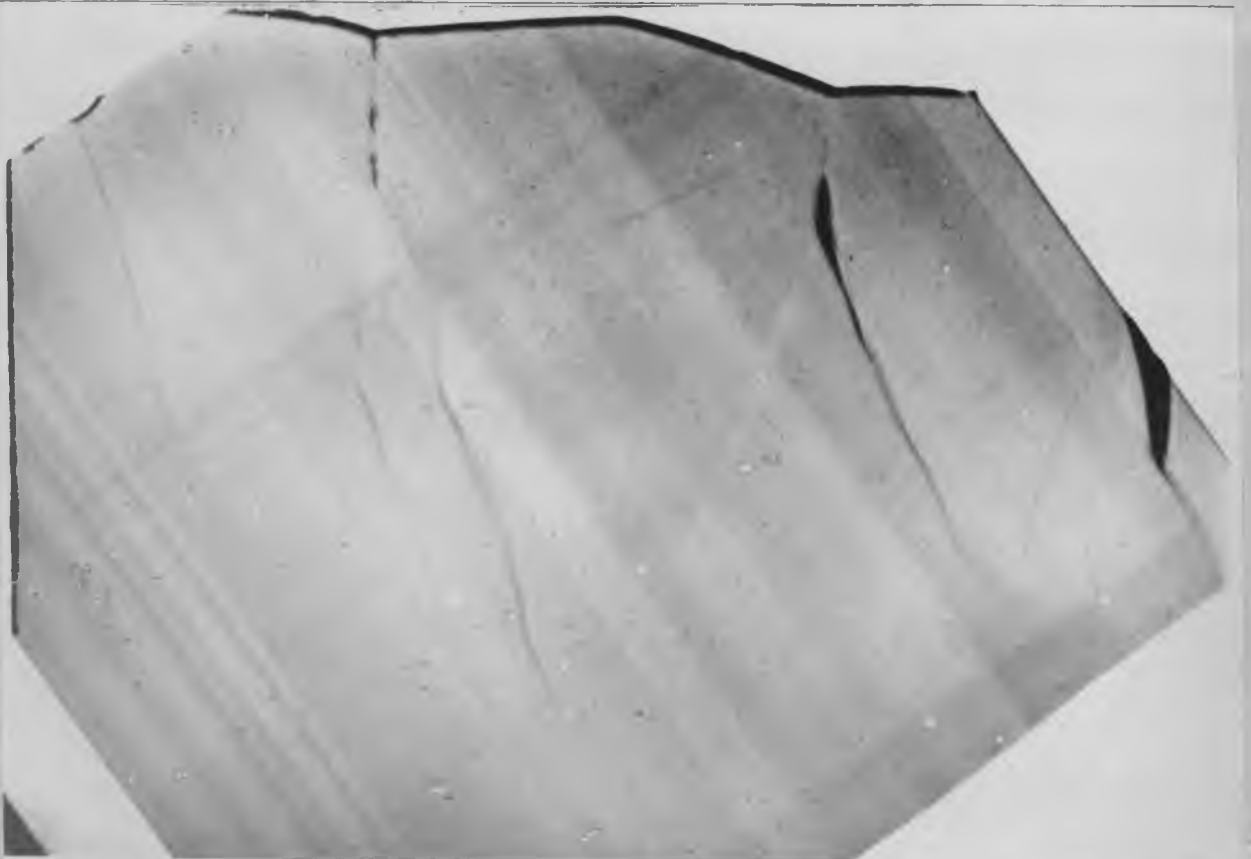
Рис. 49. Топограмма х-среза без-дислокационного кристалла кварца с аксессуориями, отражение \{10\bar{1}\} .
