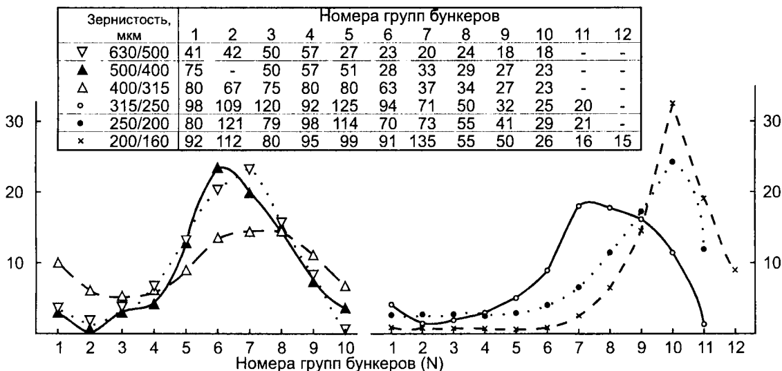
Рис. 3. Распределение по бункерам вибростоло и эффективные номера марок кристаллов алмаза, полученных в десятиминутных циклах.
