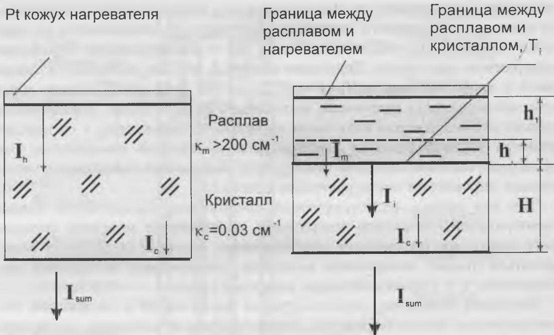
Рис. 1. Схема формирования теплового излучения в системе расплав—кристалл.
